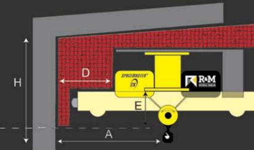
A. Disminución de la distancia del gancho a la pared (en comparación con grúas de festón de pista en C)
