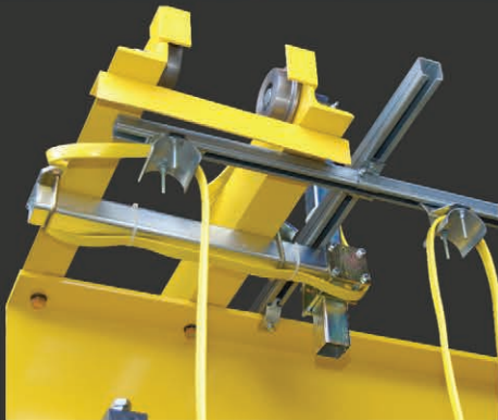
FESTÓN Viene completo con cable de poder para enchufe rápido, riel, carriel en C y carros portacables
